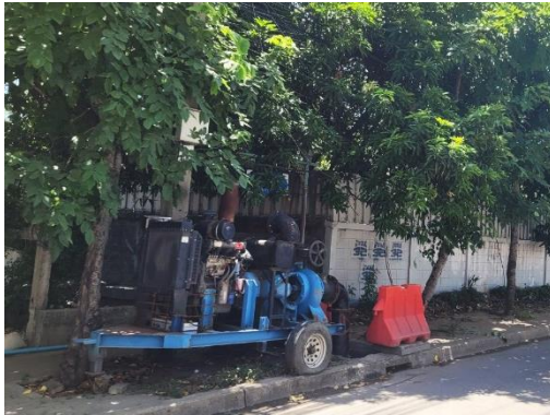
รูปที่ 2-10 การจัดเตรียมเครื่องสูบน้ำ ไว้ภายในพื้นที่ก่อสร้าง
